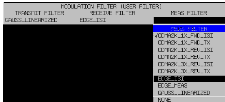
Bild 154 Definition eines neuen Filter-Sets
